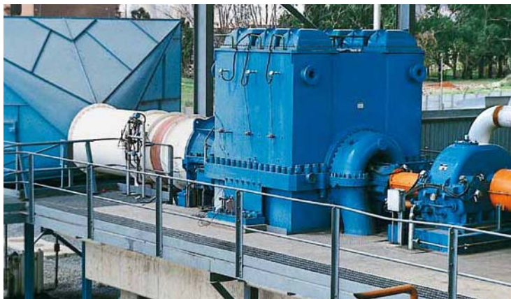
Воздушный компрессор RIK 100 на заводе по разделению воздуха
