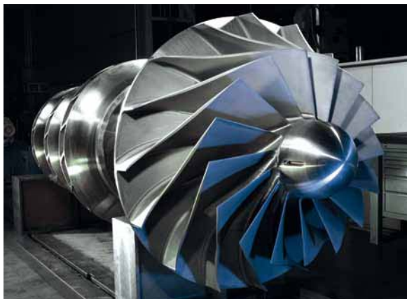
Последняя модель компрессора RIKT: Первая ступень с осевым входом представляет собой открытое рабочее колесо с консольной опорой
